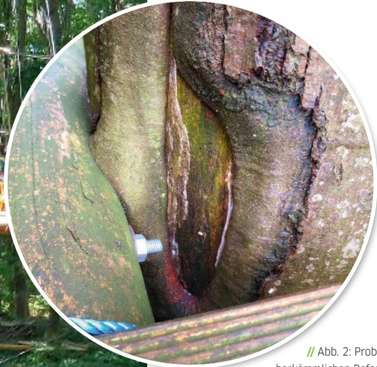
// Abb. 2: Problem bei herkömmlichen Befestigungen: Ab einem Anpressdruck von ca. 5 kg/cm<sup>2</sup> wird der stoffwechselnde Saftfluss im Kambium unterbrochen, was zu Rindennekrosen führen kann. //
